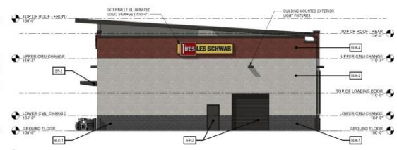
3 LOADING ELEVATION SCALE: 1/8" = 1'-0"
