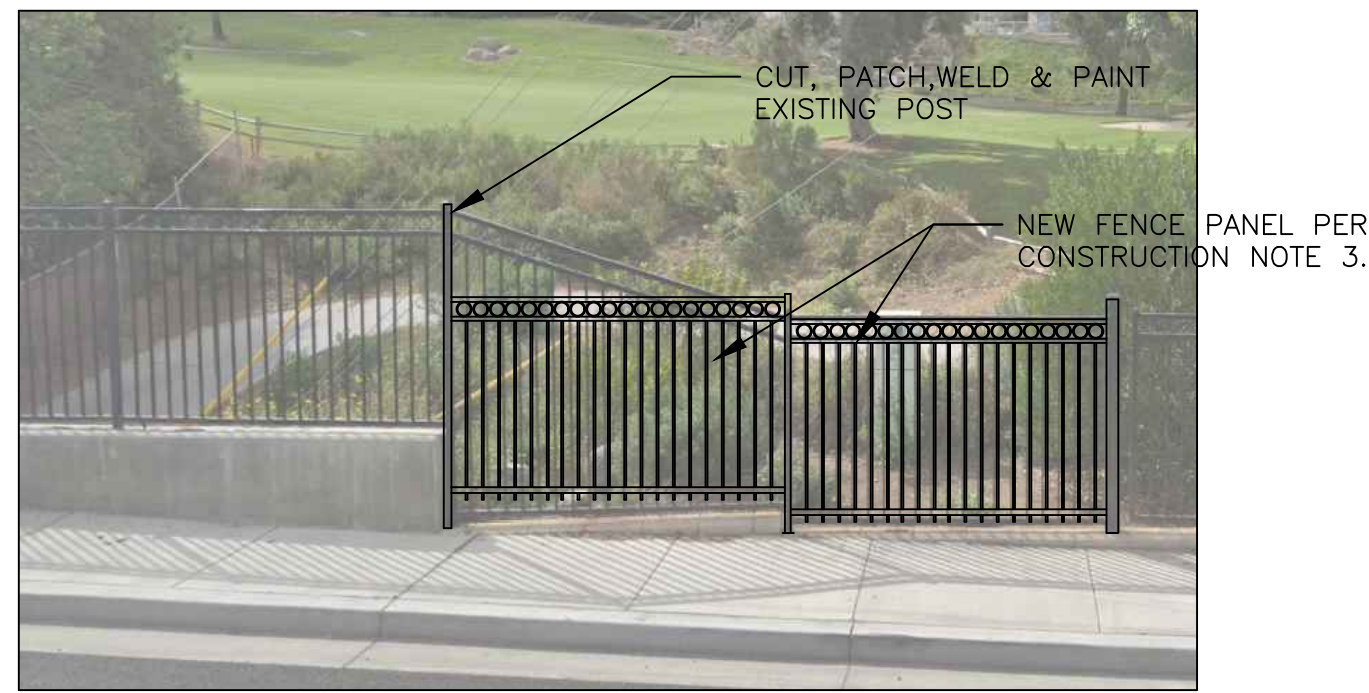
DETAIL A (CONSTRUCTION NOTE 7.) N.T.S.
