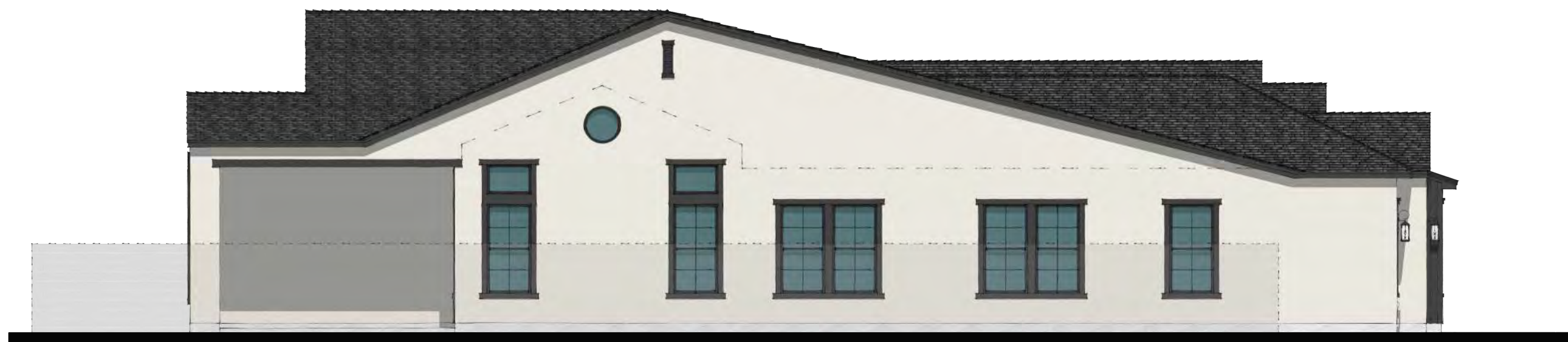
LEFT ELEVATION SCALE: 1/8" = 1'-0"
