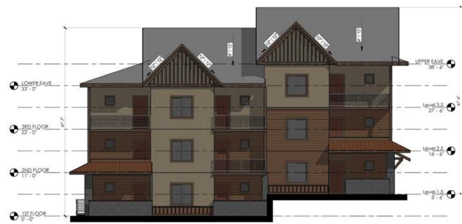
A6 EAST ELEVATION SCALE: 1/8" = 1'-0"
