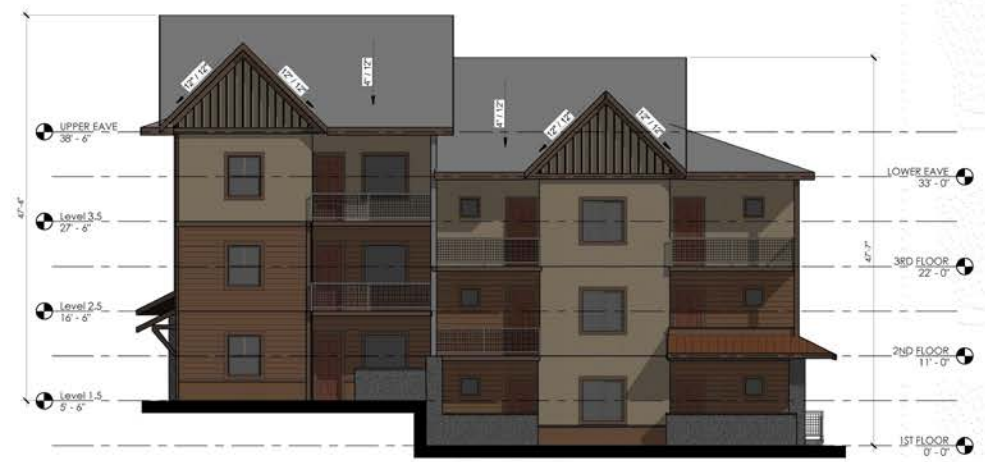
A1 WEST ELEVATION SCALE: 1/8" = 1'-0"
