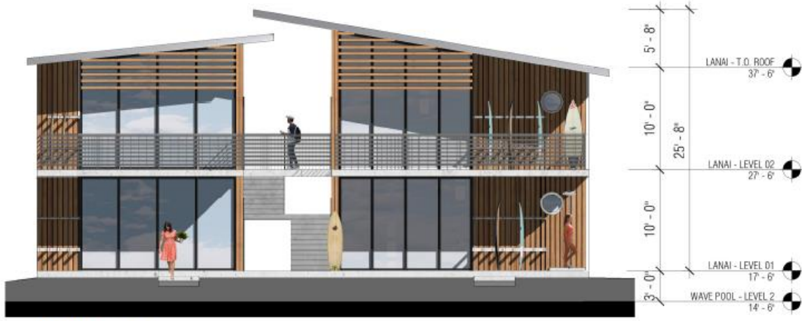
Lanai Detail Elevation SCALE: 1/8" = 1'-0"
