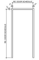
FRAME TYPE - F1 HOLLOW METAL FRAME PAINT FINISH \*
